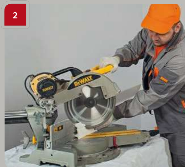
2 Stel de hoek op de verstekzaag in en zaag het product. In ruimten met hoeken van 90° is het mogelijk om een verstekbak en een handzaag te gebruiken.
